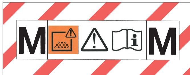
**CZ** VÝSTRAHA: Toto zařízení obsahuje zdraví škodlivý prach. Vyprázdnování a údržba, včetně vyjmout prachového sáčku, smí provádět pouze odborník, který je navíc vybaven osobní ochrannou výzbrojí. Nezapínejte dříve, než bude filtracní systém zcela nainstalován a než proběhne funkční zkouška kontroly objemového průtoku.
