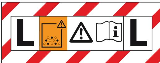
Sauger der Staubklasse L sind geeignet zum Auf-/Absaugen von trockenen, nicht brennbaren, gesundheitsgefährlichen Stäuben mit Arbeitsplatzgrenzwerten (AGWs) > 1mg/m<sup>3</sup>.
